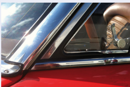
Detail Scheibe vorne links mit Scheibengummi, Zierchrom, Lack, Spaltmaß und ggf. mit Außenspiegel
